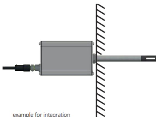
Temperaturabfall entlang des Sensor Rohrs zu vermeiden. Siehe Bild:
